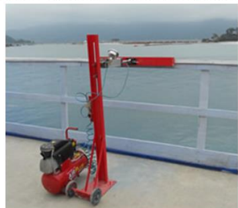
Figura 14 - Testes em Guarda-Corpo
